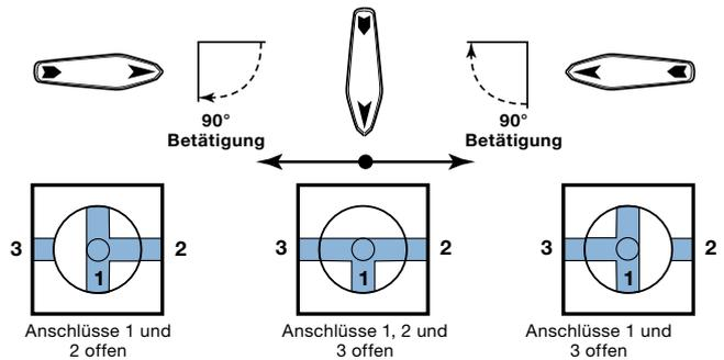
T-Bohrung mit einer Verbindung zum unteren Anschluss (Anschluss 1) ermöglicht die Auswahl der Anschlüsse 1 und 2, 1 und 3, oder 1, 2 und 3. ES GIBT KEINE GESCHLOSSENE STELLUNG.
