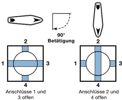
Die T-Bohrung ermöglicht die Verbindung dreier nebeneinanderliegender Anschlüsse, der verbleibende Anschluss ist geschlossen. Der Griff lässt sich um 360° drehen.
