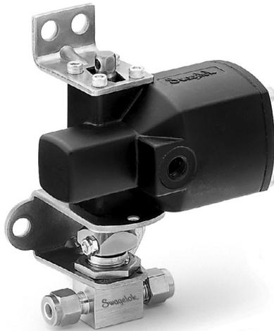
Pneumatische Steuerköpfe von Swagelok sind kompakt, leicht und einfach zu montieren. Die Steuerköpfe sind in den Ausführungen mit Federrückholung und mit Doppelbetätigung lieferbar. Hähne in gerader Ausführung und Winkelausführung und 3-Wege-Hähne mit **H-** und **L-**Fließmustern erfordern eine Betätigung von 90°; alle anderen 3-Wege Hähne erfordern eine Betätigung von 180°.
