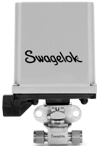
Elektrische Steuerköpfe von Swagelok können eingesetzt werden, um die Position von Swagelok Kugelhähnen zur Instrumentierung zu überwachen; es gibt Modelle für den Betrieb mit Wechsel- oder Gleichstromversorgungen. Mittels eines elektrischen Signals kann die Stellung des Hahns ferngesteuert verändert werden. Integrierte Endschalter geben selbst zwischen den einzelnen Positionen ein Ausgabesignal mit der Hahnstellung ab. Die Antriebswelle dieser Steuerköpfe rotiert in einer Richtung.
