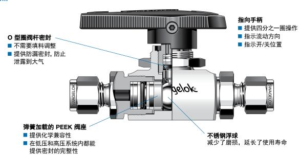
世伟洛克® SK 系列球阀采用紧凑型设计, 具有扭矩低、四分之一圈操作的特点, 能够在压力最高达 6000 psig (413 bar) 的应用场合提供可靠关断。其它特点还有:
