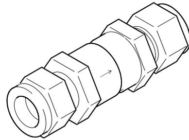
该过程中所显示的为带世伟洛克®(Swagelok®)卡套管接头端接的阀门。这些指南同样适用于带螺纹端接的单向阀和带VCR®以及VCO®端接的单向阀。
