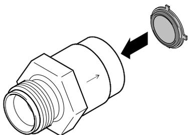
7. 插脚在前，将阀芯挡块插入阀体。
