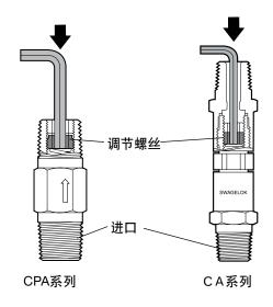
3. 顺时针同时旋转两个螺丝将增大开启压力, 逆时针旋转将减小开启压力
