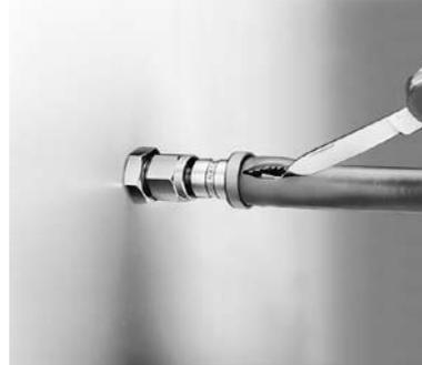
2. 将软管弯曲以暴露出倒钩, 然后快速拉动取出软管。
