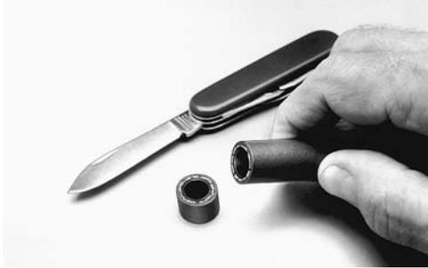
2. 用软管覆盖住端接的第一倒钩。
