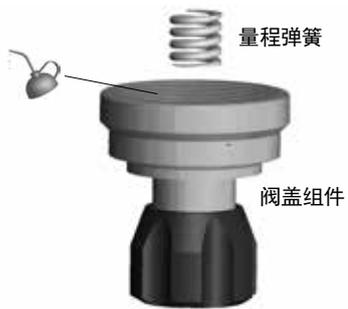
19. 将阀盖组件旋到主体上, 然后将**阀盖螺母**拧紧至 236 ft·lb (320 N·m, 32.7 m·kg)。
