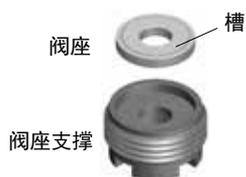
13. 通过阀座支撑件置入提升阀。然后将弹簧支撑、提升阀芯弹簧和提升阀芯密封支撑装置放置到提升阀的暴露端上。
