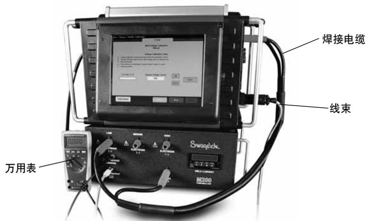
图 7 – 电压校准连接
