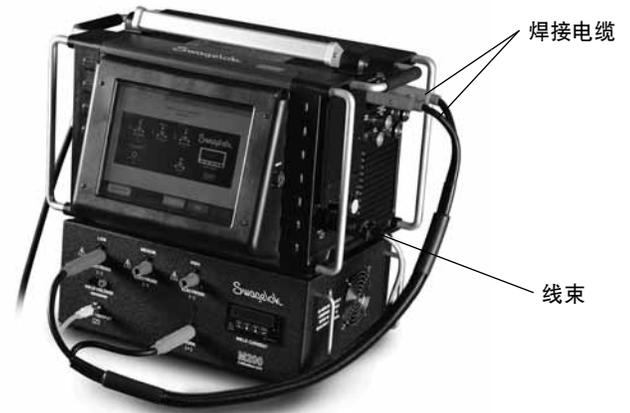
图 1 - 安装连接
