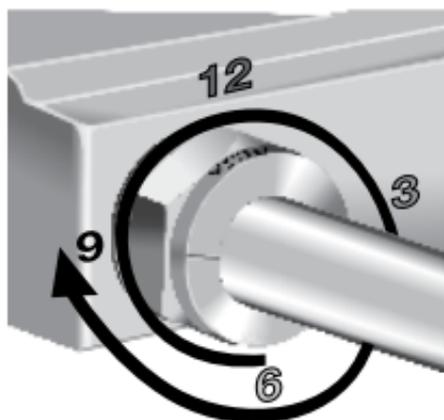
使用合适的世伟洛克间隙检测规来检查是否足够拧紧。
