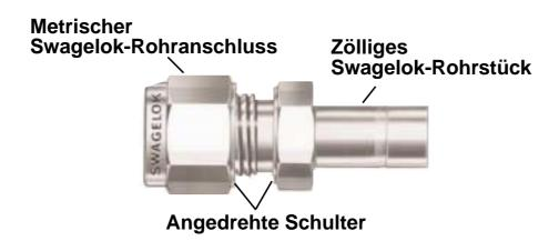
Bitte beachten: Diese metrischen Rohrverschraubungen dürfen nur mit metrischen Rohrgrößen verwendet werden. Sie sehen ähnlich aus wie Swagelok-Rohrverschraubungen in zölligen Größen. Der entscheidende Unterschied ist der Innendurchmesser der Rohrverschraubungskomponenten. Aufgrund der äußeren Ähnlichkeit der metrischen und zölligen Größen und zur einfachen Identifizierung sind Körper und Mutter mit einer angedrehten Schulter versehen. T-Stücke und Winkel tragen die Markierung MM.
