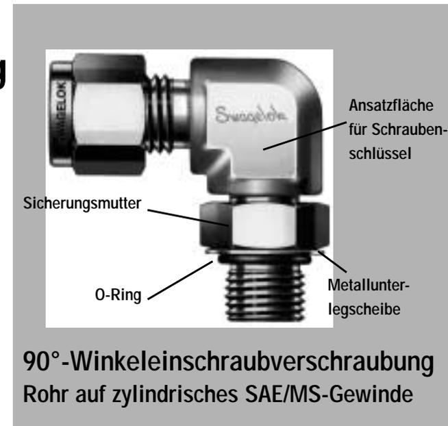
3. Positionieren Sie das Anschlussstück, indem Sie es (um nicht mehr als 1 Umdrehung entgegen dem Uhrzeigersinn) herausschrauben, bis die Swagelok-Rohrverschraubung in der gewünschten Richtung positioniert ist.
