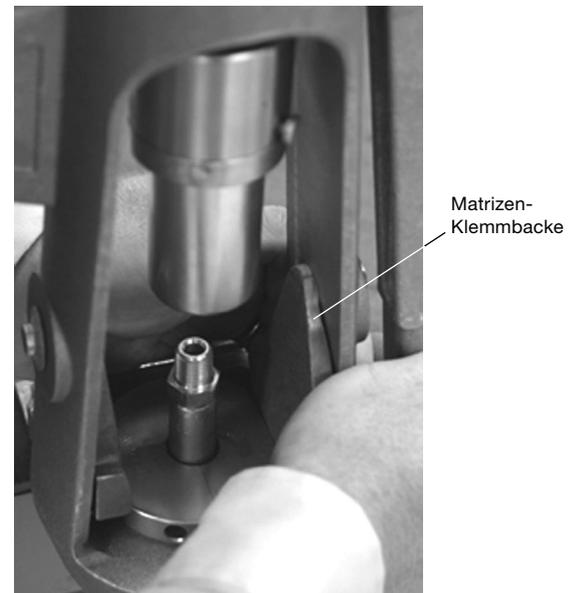
6. Die **Endanschlusshülse** an den **Matrizen** positionieren.
