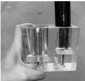
Den Schlauch mit einem Filzstift so nah wie möglich an der Einstecklehre markieren.
