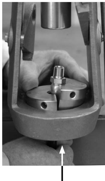
12. Entfernen Sie eine **Matrize** vom **Gehäuse** und halten Sie dabei das **verpresste Bauteil** fest. Das verpresste Bauteil durch den Boden des Gehäuses entfernen.
