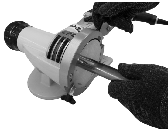
Abb. 21 Einspannen des Rohrs für TF48
