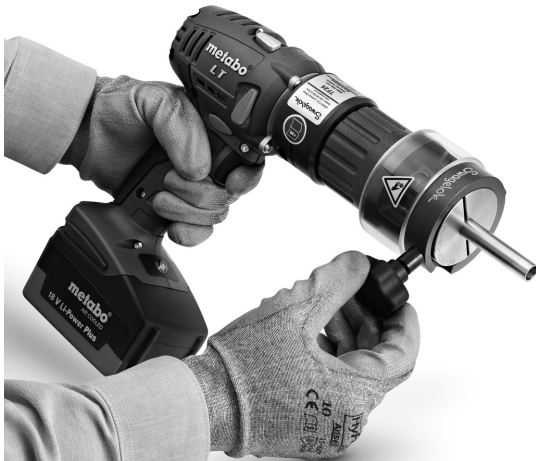
Abb. 22 Einspannen des Rohrs
