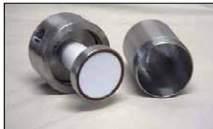
Den Membranhalter des Filterkerns wieder einbauen, falls dieser entfernt wurde. Den Membranhalter nicht weiter drehen, wenn er fingerfest an die Filterkartusche geschraubt wurde.
