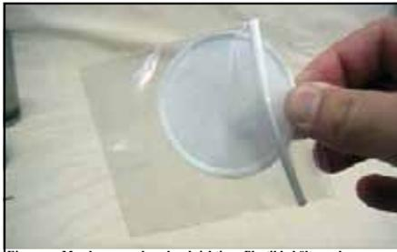
Eine neue Membran aus dem durchsichtigen Plastikbehälter nehmen. Die Membran vorsichtig an der Außenkante anfassen, damit sie nicht beschädigt wird. Die neue Membran über dem Membranhalter zentrieren.
