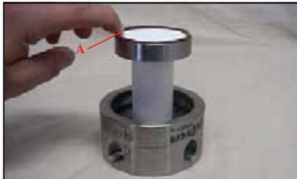
Den O-Ring über der Membran platzieren und ihn mit seiner Vertiefung ausrichten. Den O-Ring an einer Stelle leicht etwa zur Hälfte in die Vertiefung drücken.
