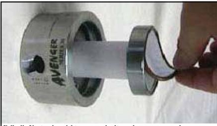
Falls die Kartusche nicht ausgewechselt werden muss, muss der Membranhalter im Filterkern nicht entfernt werden. Die alte Membran vorsichtig, ohne den O-Ring zu beschädigen, entfernen. Der O-Ring wird zur zukünftigen Verwendung aufbewahrt.
