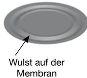
6. Die **Anschlagplatte** mit der Erhebung auf der Anschlagplatte nach oben - weg von der Membran zeigend - auf die neue **Membran** montieren.
