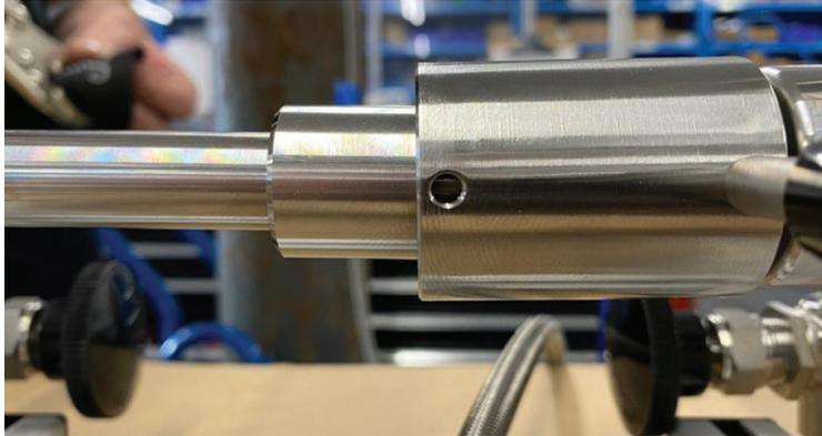
17. Sobald dies erreicht ist, ziehen Sie die Spindelmutter an der Welle fest, ohne dass sich die Spindel dabei dreht. Damit wird die Welle an der Spindel befestigt. Verwenden Sie weiche Greifvorrichtungen, um die Welle in Position zu halten, während Sie die Spindelmutter festziehen.
