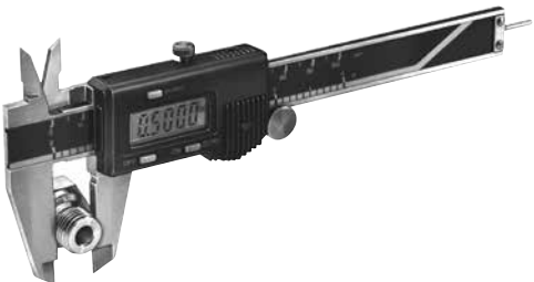
Abb. 1 Messen der Gewindedurchmesser von Spitze zu Spitze
