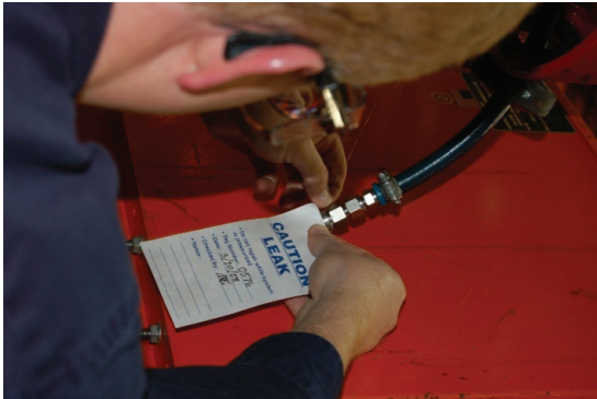
Figura 10-11 Detectar e identificar fugas.
