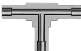
Figura 6-11 Unión en te.
