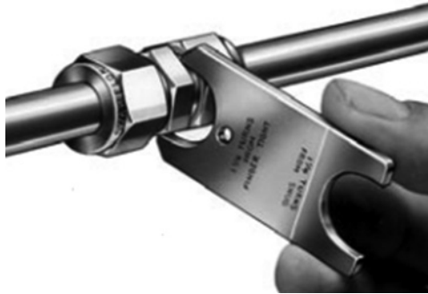
Figura 4-1 Galga de inspección de montaje.
