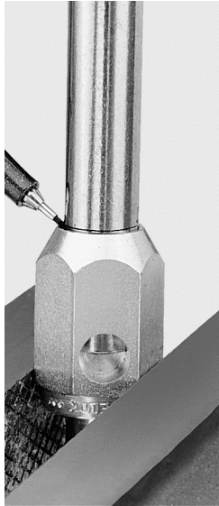
Figura 3-59 Marcar el tubo.
