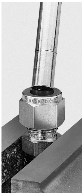
Figura 3-60 Extraer el tubo. Figura 3-61 Inspección visual de la marca.
