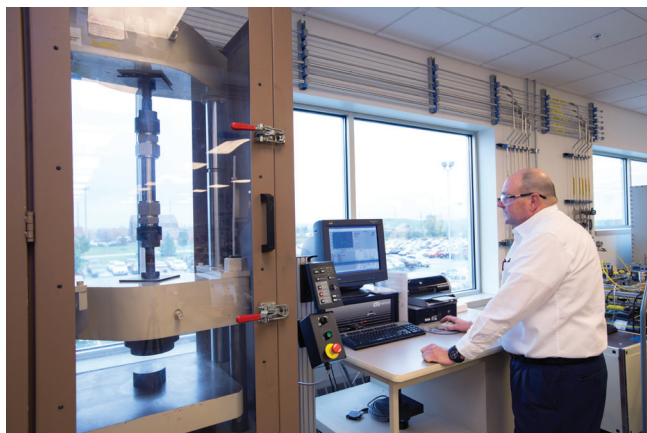
Figura 7-8 Prueba de resistencia a la tracción.
