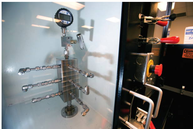
Figura 7-9 Prueba de impacto hidráulico.
