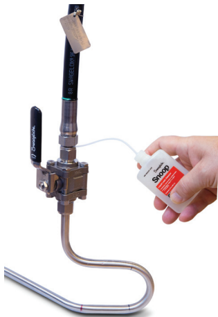
Figura 7-3 Prueba de fugas con Snoop.
