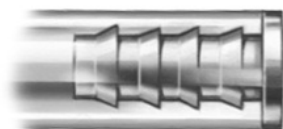
Figura 6-18 Manguito de refuerzo interior.
