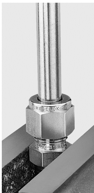
Figura 3-60 Extraer el tubo. Figura 3-61 Inspección visual de la marca.
