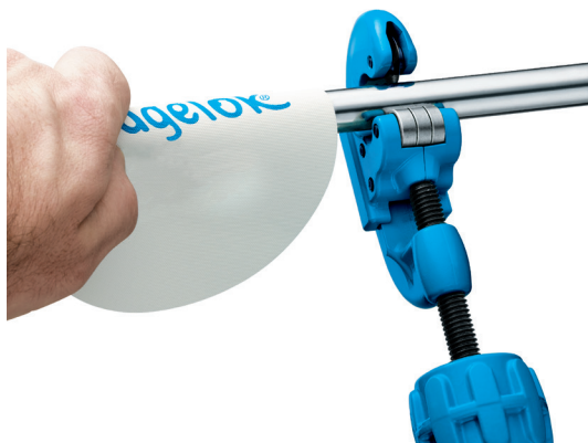
Figura 3-43 Alinear la rueda cortadora con la marca de medición.
