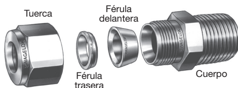
Figura 1-6 Racor Swagelok: cuatro componentes.
