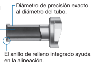
Figura 6-12 Accesorio para soldadura automática de tubo a tope.
