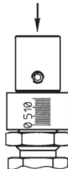
**PASO 4** Afloje el **Tornillo de la Extensión del Vástago** y deslice la **Extensión del Vástago** hacia abajo contra el **Cilindro** sin mover el vástago. Vuelva a apretar el **Tornillo de la Extensión del Vástago**. Con esto queda fijado un tope para el mando.
