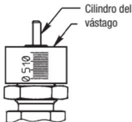
**PASO 2** Inserte el **Cilindro** en el **Bonete** hasta que haga tope contra la rosca del bonete. Gire el **Cilindro** para que pueda leerse la escala. Apriete el **Tornillo del Cilindro**.
