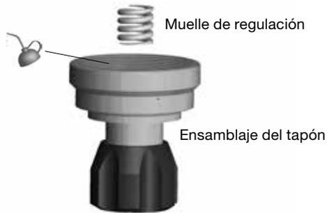
19. Rosque el ensamblaje del tapón al cuerpo y apriete el **ensamblaje del tapón** hasta 320 N·m (32,7 m·kg, 236 pies·lb).
