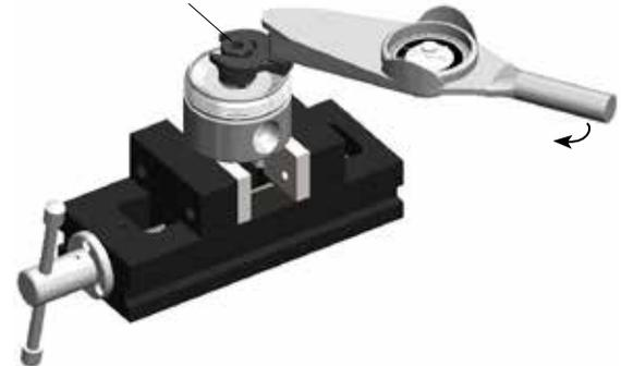
16. Instale el **diafragma** en el **cuerpo** con el pliegue grande mirando hacia abajo, hacia dentro del cuerpo.
