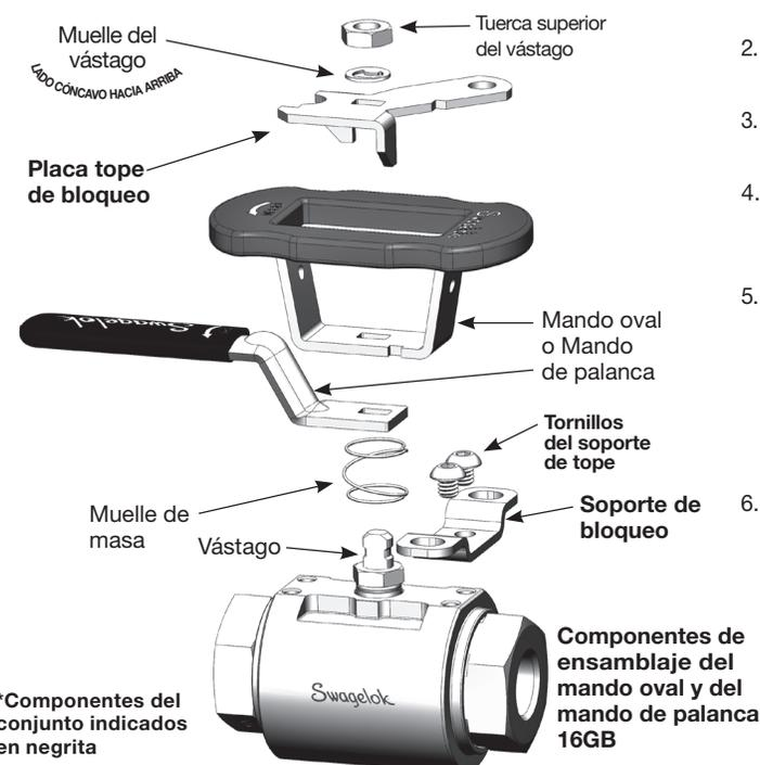
2. Retire las siguientes piezas: **tuerca superior del vástago, muelle del vástago, placa tope sin bloqueo, mando, y muelle de masa.**
