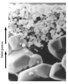
Cette image prise au microscope à balayage électronique montre les deux couches de membranes de l'élément de filtre, la très fine et la fine (respectivement en haut et en bas)
