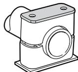
Étape 4. Placez le couvercle sur l'assemblage du corps.
