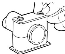
Étape 5. Insérez les vis à tête six pans à travers le couvercle et l'assemblage du corps. Serrez fermement à la main.
