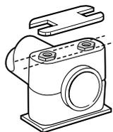
Étape 3C – Alignez les vis d'empilage jusqu'à ce que les méplats hexagonaux puissent recevoir la plaquette d'arrêt.
