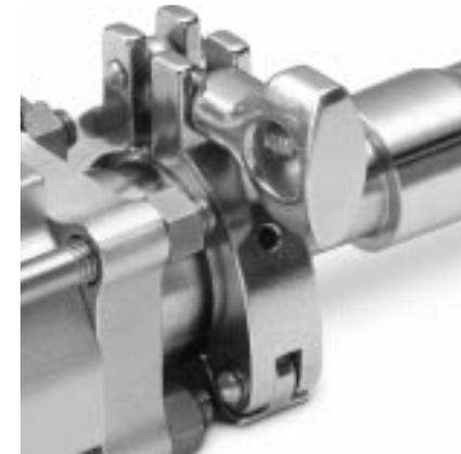
4. Mettez le collier en place et serrez l'écrou à oreilles jusqu'à obtention d'un contact métal sur métal. Pour faciliter le serrage approprié des joints et joints d'adaptateurs PTFE, vous pouvez utiliser un outil de serrage Swagelok pour écrou à oreilles.
