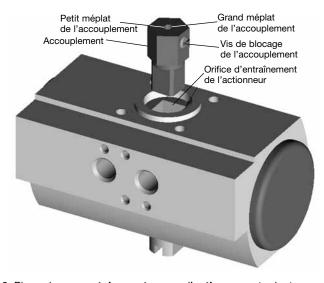
Placez le support de montage sur l'actionneur et orientezle de la manière souhaitée. Vérifiez que l'accouplement est bien dans la position qui lui permet de maintenir le sens de passage souhaité.  Fixez le support de montage sur l'actionneur à l'aide des (4) vis à tête cylindrique à six pans creux et serrez les vis au couple requis.
