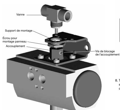
8. Testez le bon fonctionnement de la vanne avec de l'air sous pression ou selon les recommandations du fabricant de l'actionneur.
