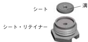
12. ポベットをシートにセットします。ポベット・スプリングおよびポベット・ダンパーをポベット端面の露出部分にセットします。
