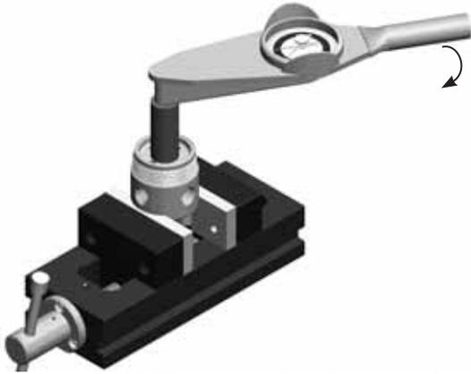
15. ピストン・シール挿入用ツールの下部をピストン・ガイドに差し込みます。ピストン・シール/ピストン・シール・スプリングをピストン・ガイドに差し込み、ピストン・シール挿入用ツールの上部を使用してシールを所定の位置に押し込みます (15A)。次に、ピストン・シール・リテーナーを差し込み、ピストン・シール挿入用ツールの上部を使用して所定の位置に押し込みます (15B)。
