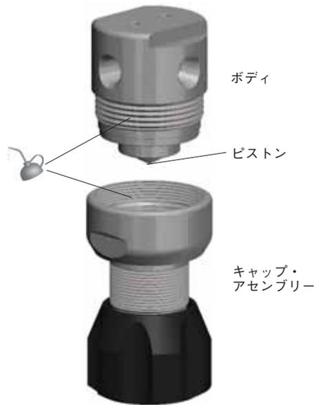
22. キャップ・リングを 135 N·m のトルク値で締め付けます。
