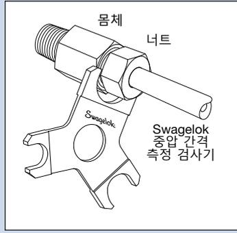
최초 설치시, 설치자 또는 검사자는 Swagelok 중압 간격 측정 검사기를 사용하여 피팅이 확실히 조여졌는지를 확인할 수 있습니다.
