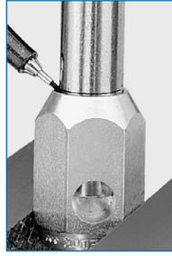
Swagelok 깊이 표시 공구를 사용하면, 튜빙을 Swagelok 튜브 피팅 몸체 턱 부분에 정확히 밀착시킬 수 있습니다.
