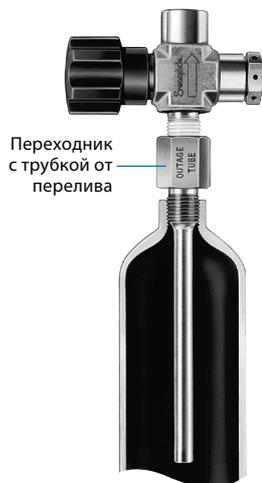
Трубки от перелива могут также привариваться непосредственно к входу с наружной резьбой игольчатого клапана Swagelok с невращающимся штоком. Затем клапан вкручивается в отверстие пробоотборного цилиндра с внутренней резьбой.
