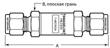
Указанные габариты соответствуют затяжке гаек на трубных обжимных фитингах Swagelok вручную.
