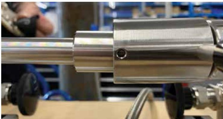
17. После сборки соединения затяните гайку штока на валу таким образом, чтобы шток не поворачивался. Так вал будет закреплен на штоке. Чтобы удерживать вал на месте во время затяжки гайки штока, используйте мягкие зажимные губки.
