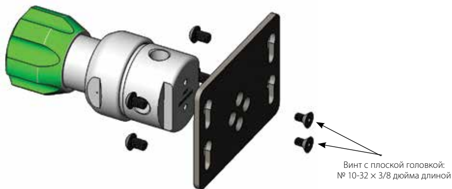
Монтаж регулятора серии KPR и кронштейна
