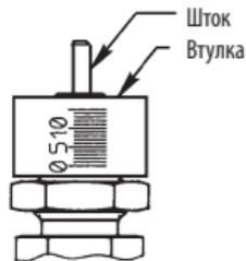
**ЭТАП 2.** Наденьте **втулку** на **крышку** до упора в резьбу крышки. Поворачивайте **втулку**, пока шкала не станет различима. Затяните **винт втулки**.
