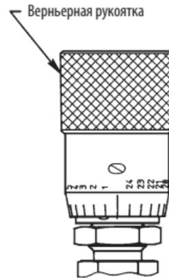
**ЭТАП 5.** Установите **верньерную рукоятку** на **удлинитель штока** и совместите нулевую отметку на **рукоятке** с нулевой отметкой на **втулке**. Затяните **винт рукоятки**. Испытайте клапан на предмет надлежащей работы.
