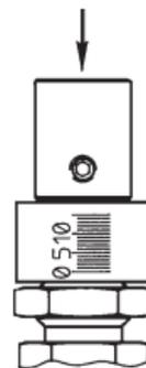
**ЭТАП 4.** Ослабьте **винт удлинителя штока** и сдвиньте **удлинитель штока** вниз относительно **втулки**, удерживая шток в прежнем положении. Снова затяните **винт удлинителя штока**. Жесткий упор рукоятки установлен.
