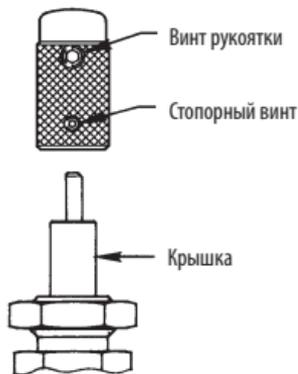
**ЭТАП 1.** Ослабьте **стопорный винт** (только серии S и M), затем ослабьте **винт рукоятки**. Снимите рукоятку. Примечание. Если клапан предназначен для монтажа на панель, смонтируйте его, прежде чем продолжить.
