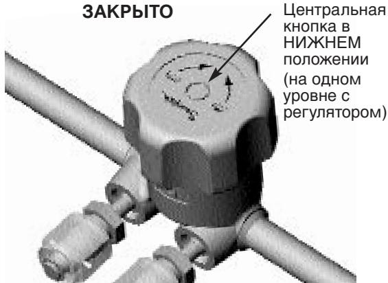
Для закрытия клапана поверните регулятор по часовой стрелке на два с половиной оборота.
