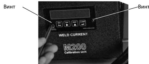
Рис. 12 — винты панельного измерительного блока
