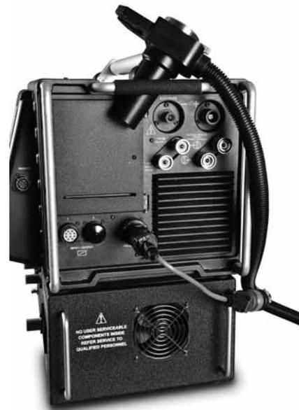
Рис. 9 — соединения для проверки скорости (показаны с дополнительным кабелем-переходником для сварочной головки)
