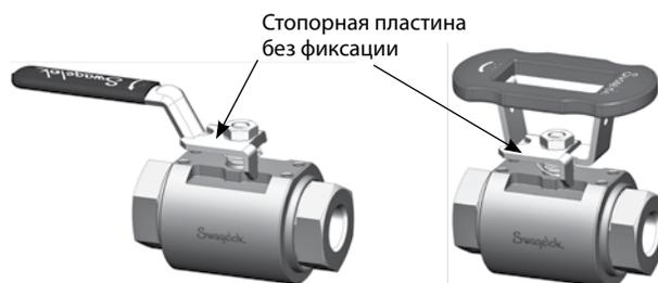
Установленные в заводских условиях рукоятки без фиксации находятся в открытом положении
