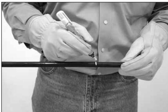
1. Сделайте отметку на оболочке трубки в месте предполагаемого реза.
