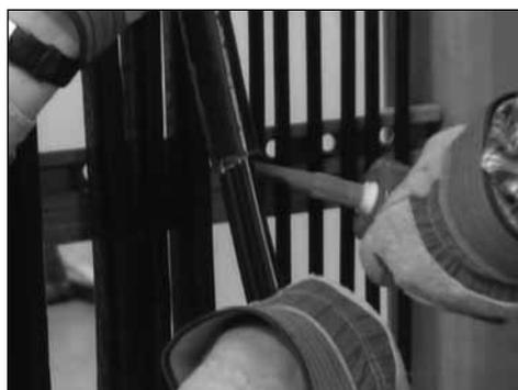
6. Нанесите силиконовый герметик на обрезанный шов там, где была снята наружная оболочка.
