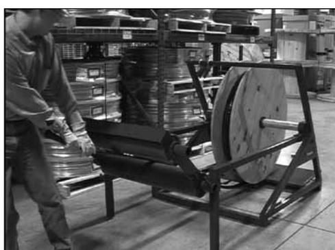
6. Равномерными движениями протягивайте трубку через узел роликов.
