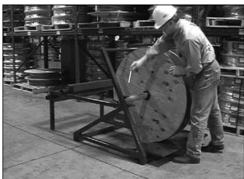
2. Используйте скат для загрузки катушки и установите шпindel в С-образный кронштейн на устройстве. Установите стопорные штифты в отверстия на С-образном кронштейне для закрепления катушки в устройстве.
