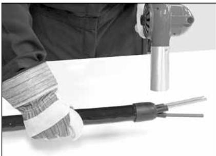
3. С помощью промышленного фена усадите кожух на трубке. Перемещайте источник тепла туда и обратно над кожухом, подавая тепло равномерно. После того как кожух примет форму трубки, прекратите подачу тепла. Дальнейший нагрев не даст улучшения в усадке кожуха.
