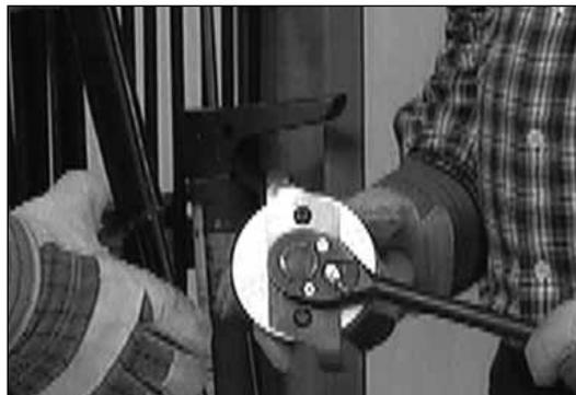
1. Вставьте кронштейн инструмента между трубками так, чтобы нужная трубка оказалась между кронштейном инструмента и башмаком для гибки.
