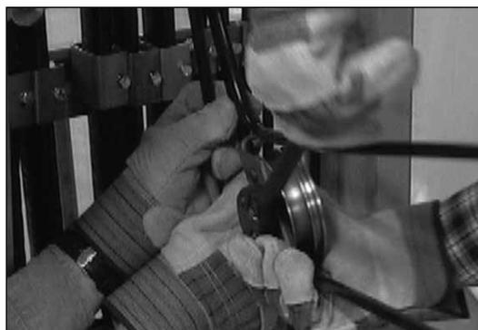
2. Используйте желоб на башмаке для гибки, который лучше всего подходит для данной трубки. Крепко удерживая трубку, с помощью храпового механизма с квадратным соединительным профилем 1/2 дюйма поверните башмак и изогните трубку на требуемый угол.
