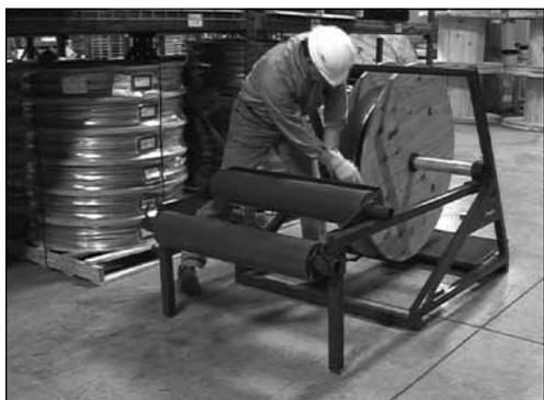
3. Вытяните трубку снизу катушки.
