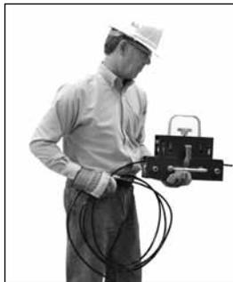
**Метод 4.** Установите катушку на устройство для размотки с подсоединенным пятироликовым распрямителем.
