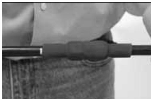
6. После завершения муфта должна быть единообразной и должен быть виден тонкий слой клея между термоусадочной муфтой и оболочкой.
