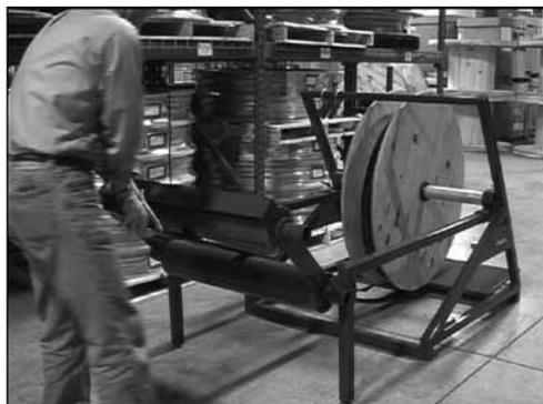
5. Поверните узел роликов в направлении к оператору.
