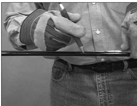
1. Выполните расчет изгиба обычным образом. См. руководство Swagelok для монтажника трубок, MS-13-03.
