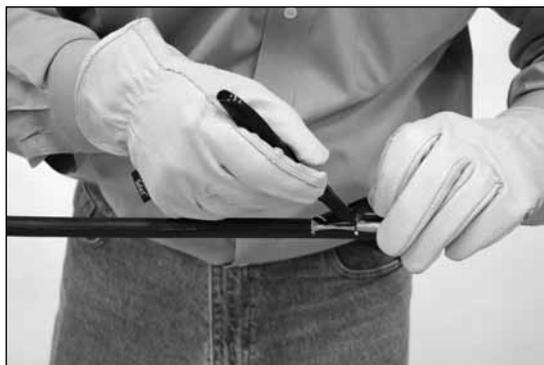
6. Отметьте место реза на трубке.
