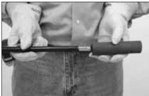
1. Наденьте муфту на трубку перед выполнением соединения. На внутреннюю поверхность муфты нанесен активируемый при нагревании клей.
