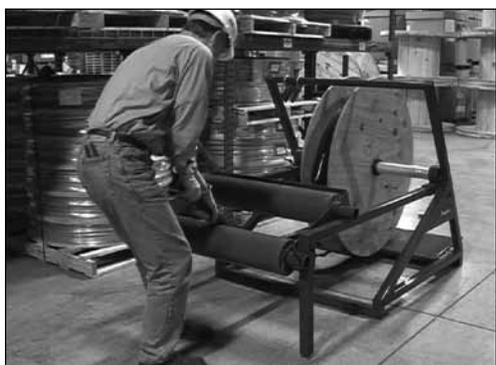
4. Протяните трубку между роликами.
