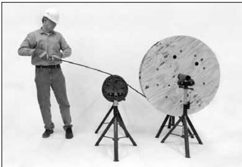
**Метод 3.** Используйте пятироликовый распрямитель труб Swagelok для распрямления очищенных трубок и трубок в оболочке размером от 1/8 до 1/2 дюйма. Дополнительные сведения см. в инструкции Swagelok MS-CRD-0147.
